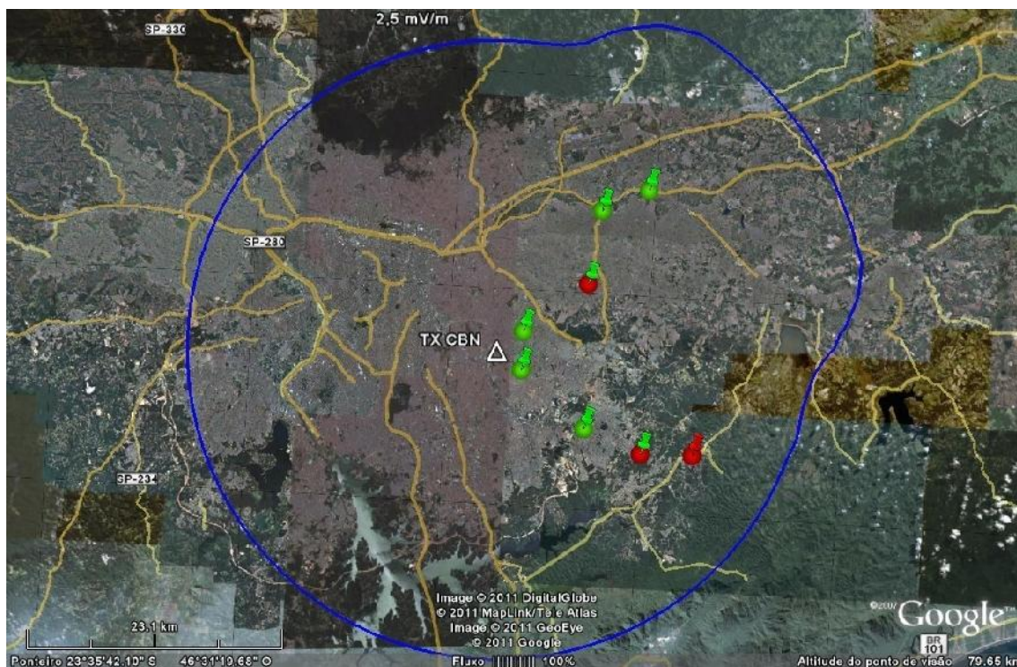
Figura 63 - Mapa da comparação entre sinal digital 16QAM noturno e sinal analógico noturno
